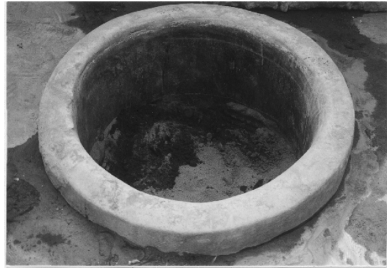
案例10-2 屋後古井大量噴砂，細砂並將四週水溝阻塞
